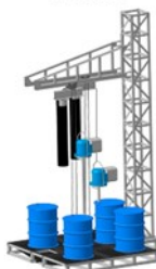
Станция перекачивания растворов из барабанов и бочек
