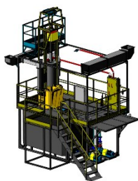
Комплекс растаривания и приготовления раствора (барabanы)
